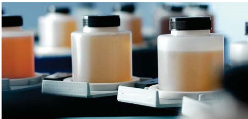
Passeur équipé d'une diode germanium pour la mesure de la radioactivité au sein d'échantillons urinaires par spectrométrie \gamma .
